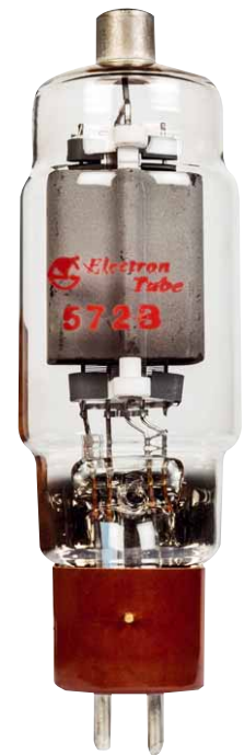
Die 572B ist eine auch heute noch verwendete Senderöhre, sie beruht auf der bekannteren 811A
